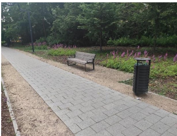
Fot. 2: Wolna przestrzeń obok ławki umożliwia swobodne zatrzymanie się osobie poruszającej się na wózku poza ciągiem komunikacyjnym, autor: K. Rawski.
