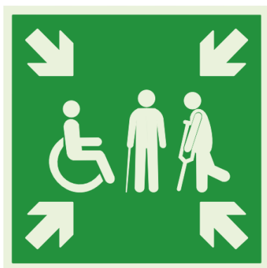
Rysunek 4. Proponowane oznaczenie punktu zbiórki dla osób potrzebujących dodatkowej pomocy / asysty przy ewakuacji – źródło [2]
