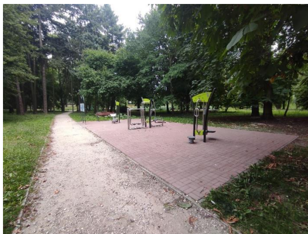
Fot. 3: Rozgraniczenie obszarów o odmiennych funkcjach z wykorzystaniem nawierzchni o różnych fakturach, autor: K. Rawski.
